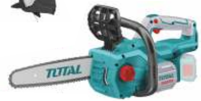
TGSLI20128 Αλυσοπρίονο μπαταρίας λιθίου 20V Μπαταρία 20V Ισχύς 900W Μήκος λάμας 30cm/12" Ταχύτητα αλυσίδας 7.9m/sec Βάρος 4,2Kg
